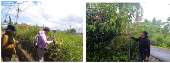
Gambar 2 Pengambilan Titik Batas Bidang Tanah
